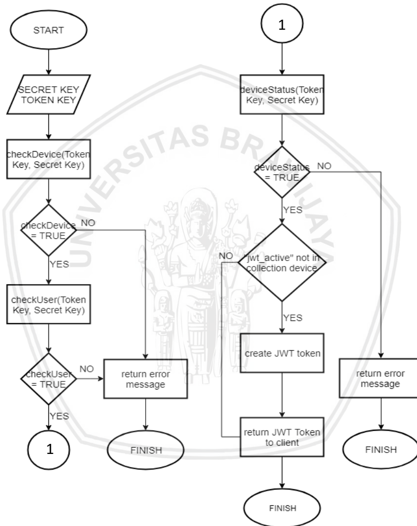
Gambar 4.8 Alur proses otentikasi menggunakan JWT
