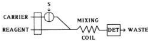
Gambar 2.4: Komponen rangkaian sederhana analisis injeksi alir
