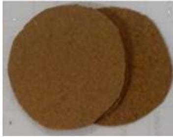
**Gambar 2.5** Filter partikulat berbahan sabut kelapa dan lem kanji dengan perbandingan tertentu (Pawestri dkk., 2014)
