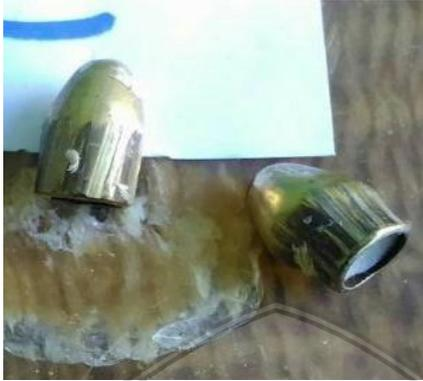
Gambar 4.13 Keadaan peluru setelah menumbuk sampel
