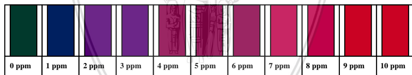
Gambar 4.8 Deret warna kompleks Pb(II)-ditizonat menggunakan ditizon 40 ppm
