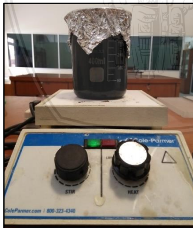
Gambar 3.3 Karbon yang mengalami proses penetralkan dengan diaduk menggunakan magnetic stirrer
