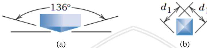
Gambar 2.8 Bentuk indentor uji vickers microhardness (a) tampilan samping (b) tampilan atas (Callister dan Rethwisch, 2014)
