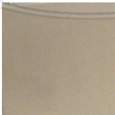
Gambar 4. 2 Permukaan baja tahan karat AISI 316L tanpa perlakuan
