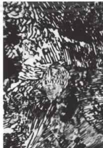
Gambar 2. 7 Struktur mikro perlit (Callister & Rethwisch, 1991).
