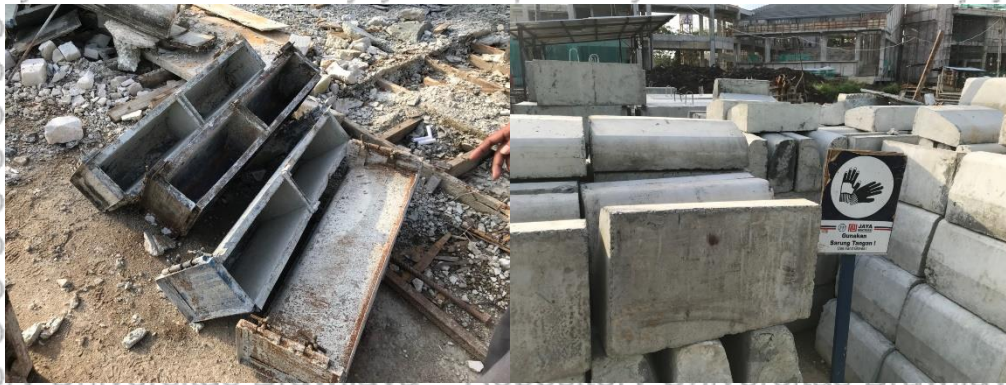
Gambar 4.136 Pemanfaatan Sisa Material Semen Portland Pada Campuran Kanstein
