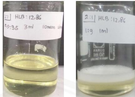
**Gambar 5.1 Hasil Optimasi Formula Nanoemulsi HLB 12,86 dengan Surfaktan : Kosurfaktan (2:1)**
