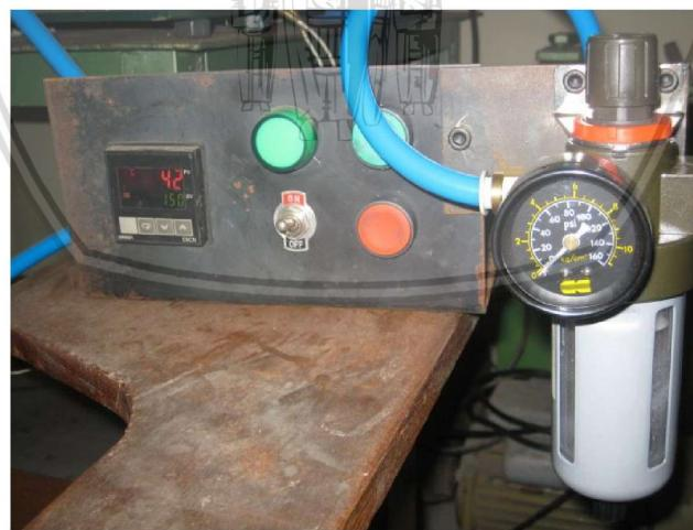
Gambar 4.8 Kontrol Mesin Press Pneumatik
