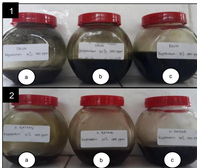
Gambar 7. Hasil ekstrak lama waktu evaporasi 40 menit (a), 50 menit (b) dan 60 menit (c) pada daun (1) dan kulit batang (2) *S. caseolaris*
