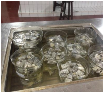
Kulit ikan diekstraksi perbandingan kulit:akuades (1:6 b/v) dengan suhu 55°C selama 4 jam.
