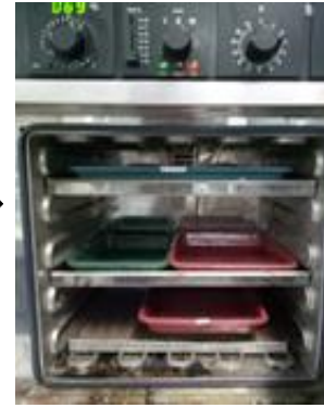
Pengeringan menggunakan oven pada suhu 60°C selama 3-4 hari
