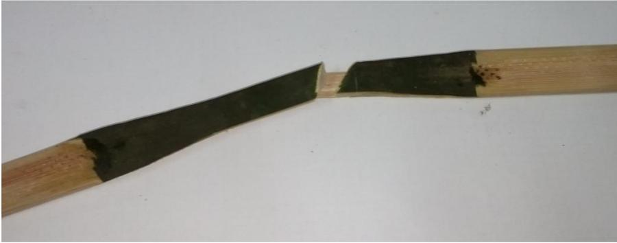
Gambar 4. 4 Sampel Bambu yang Patah/Putus
