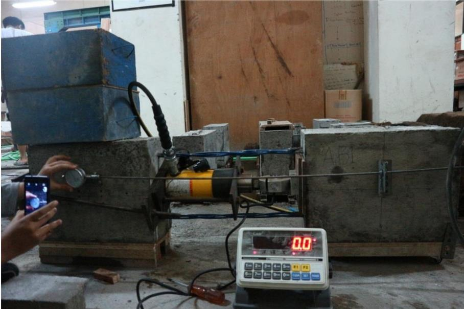
Gambar 4. 7 Pengujian Benda Uji *Pull Out*
