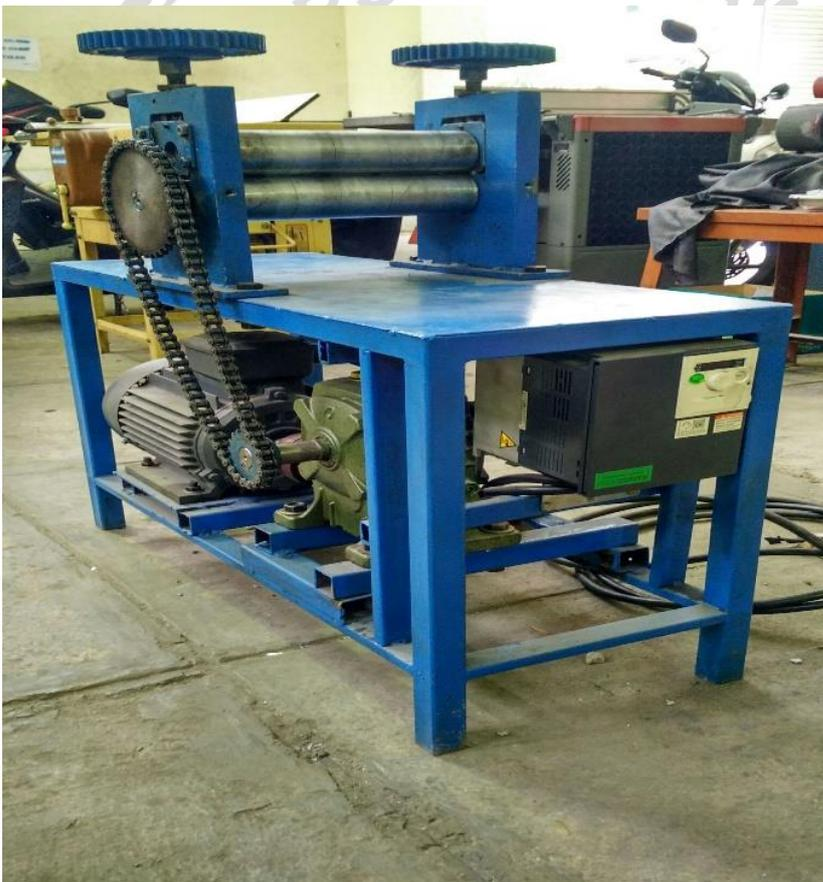
Gambar 3.1 Mesin roll bonding
