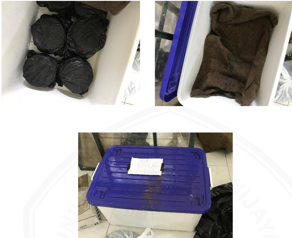
Gambar 1. Perlakuan perawatan terhadap benda uji CBR.
