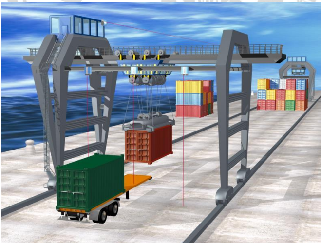
Gambar 4.18 Ilustrasi konsep laser scanner pada STS Sumber: Taneja, Schuylenburg & Vellinga (2010)
