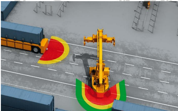
Gambar 4.19 Ilustrasi konsep laser scanner pada CTT dan SC Sumber: Taneja, Schuylenburg & Vellinga (2010)
