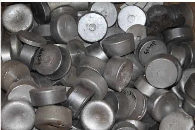
Gambar 3.13 Aluminium ingot Al-Zn
