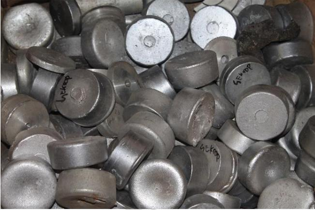
Gambar 3.13 Aluminium ingot Al-Zn
