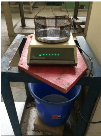
Gambar 3.11 Alat uji piknometri
