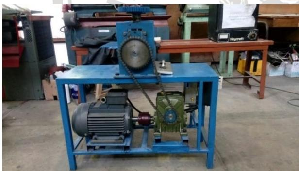
Gambar 3.1 Mesin *roll bonding*
