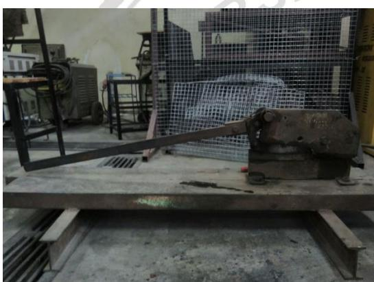
*Gambar 3.4 Mesin pemotong plat*
