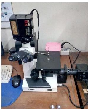
Gambar 3.15 Mikroskop logam
