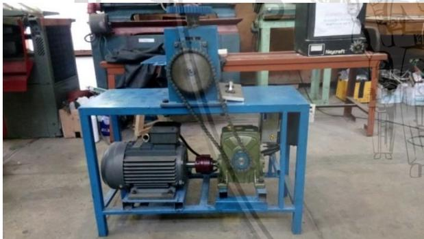
Gambar 3.1 Mesin *roll bonding*
