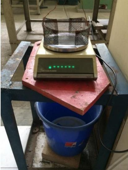
Gambar 3.11 Alat uji piknometri
