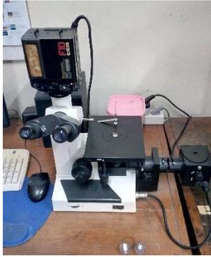
Gambar 3.15 Mikroskop logam
