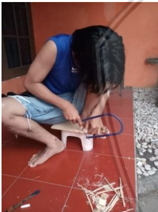
Gambar 4.13 Pembentukan spesimen sesuai ASTM ASTM D 638 – 03
