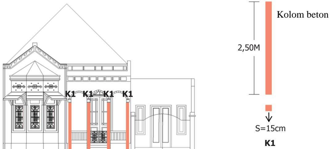
Gambar Letak Kolom pada Bangunan F
