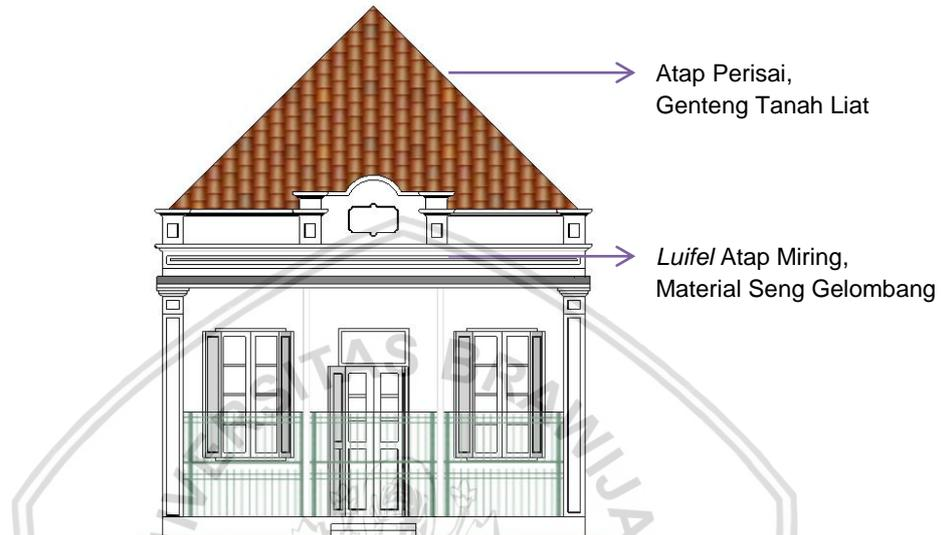
Gambar 4.26 Atap pada Bangunan C
