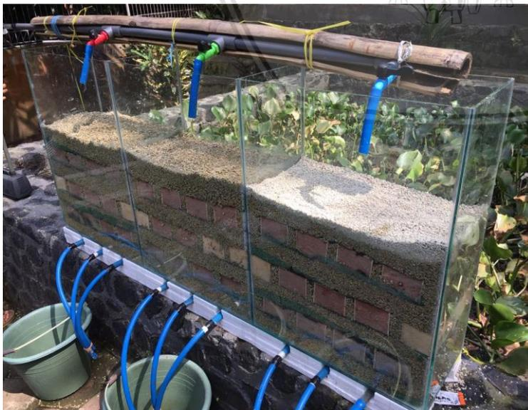
*Gambar 4.5* Komposisi Reaktor Percobaan 2
