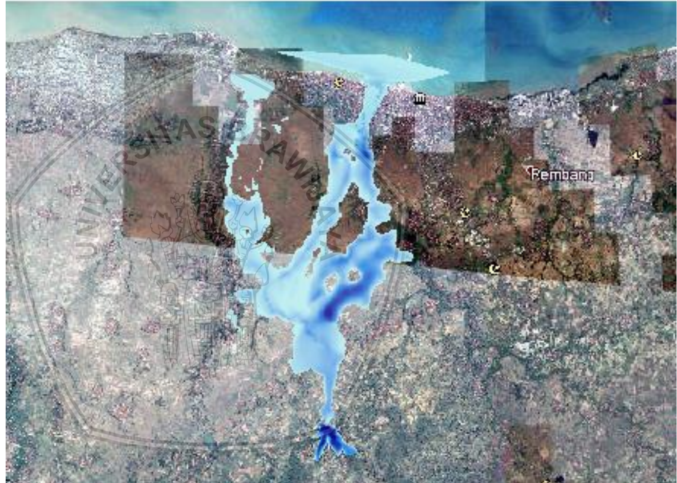
Gambar 4.28 Pemetaan Genangan Banjir Akibat Keruntuhan Bendungan Banyuwung Karena Overtopping Dengan Citra Google Earth
