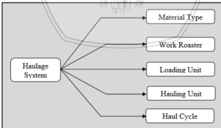
Gambar 2.8 : Komponen Haulage System *TALPAC*
