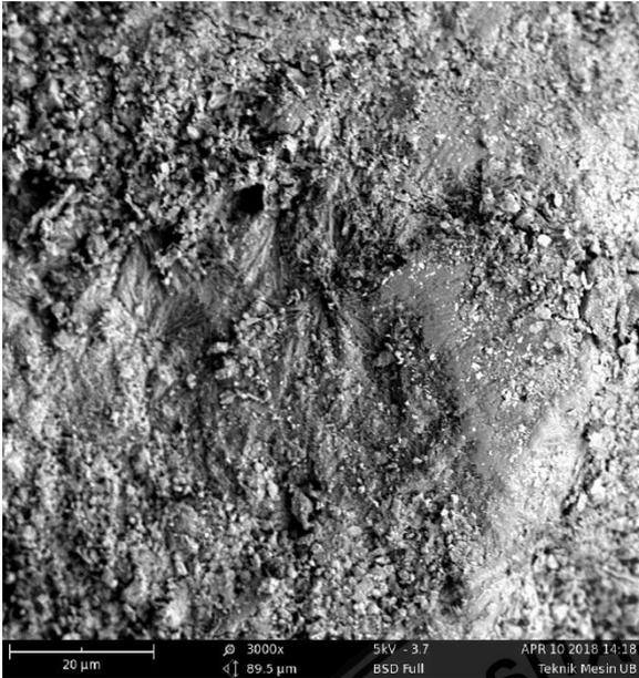
Gambar 4.6 Struktur Zeolit
