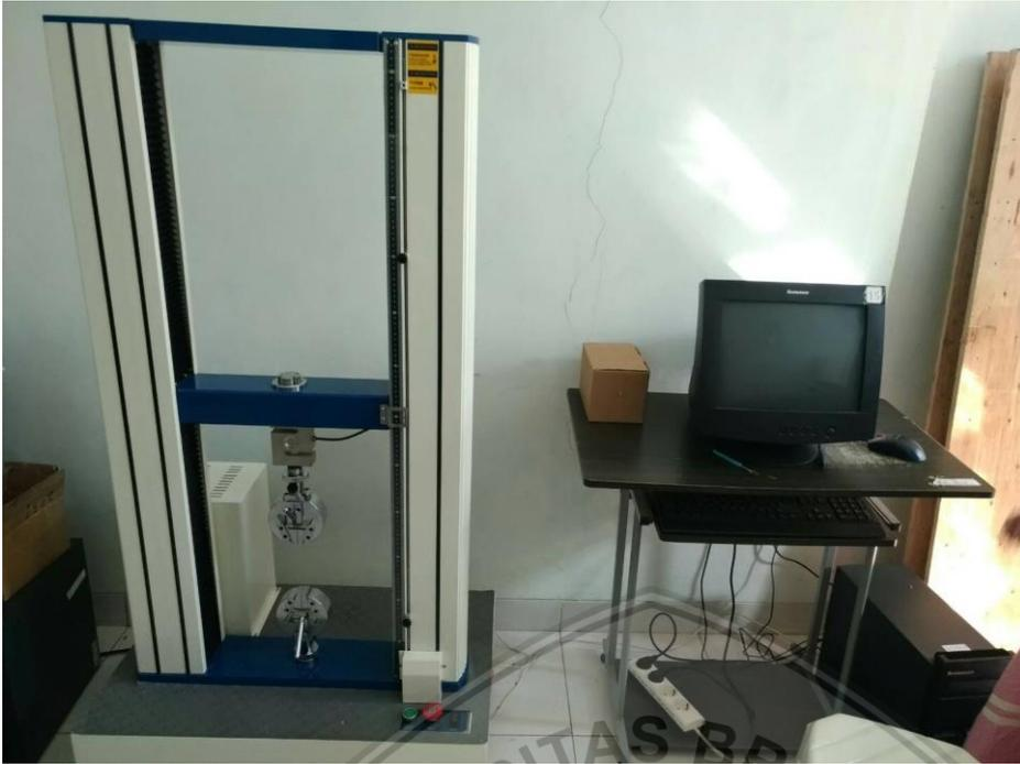
Gambar 3.9 Mesin Uji Tarik
