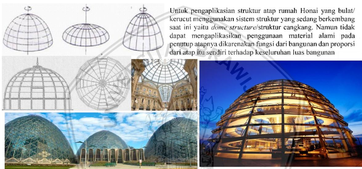
Gambar 4.37 Analisis Struktur Dome
