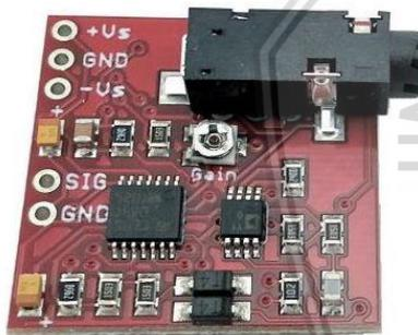
Gambar 2.7 Bentuk Muscle Sensor V3
