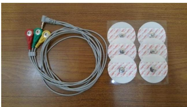
Gambar 2.4 Bentuk Fisik *Surface Electrode* dan Kabel Konektor EMG
