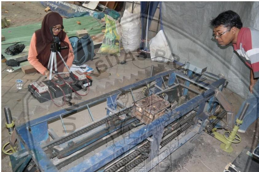
Gambar 4. 26 Pemasangan kabel dan handycame pada Alat Strain Meter
