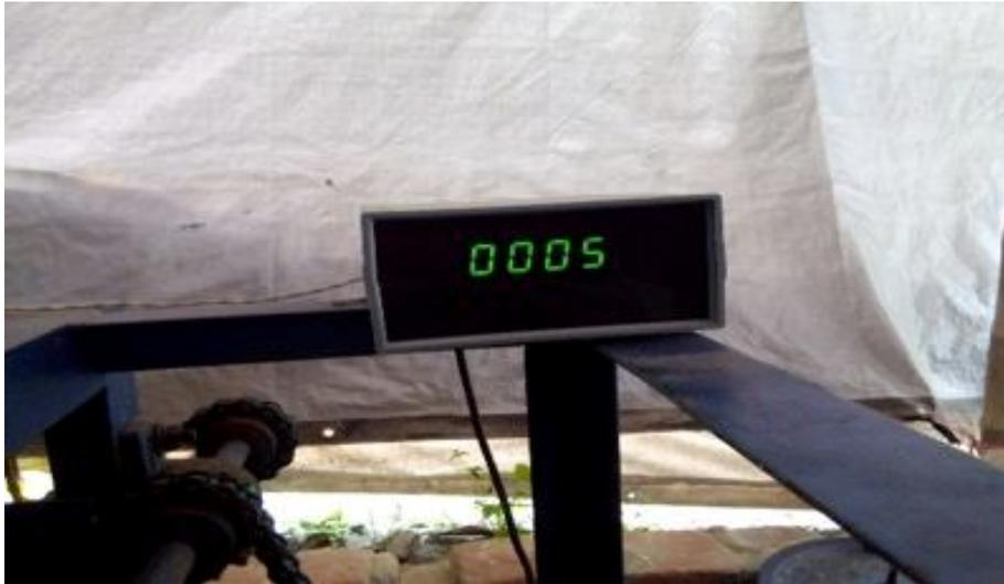
Gambar 4. 9 Alat Penghitung Lintasan (Counter) pada Mesin Penguji
