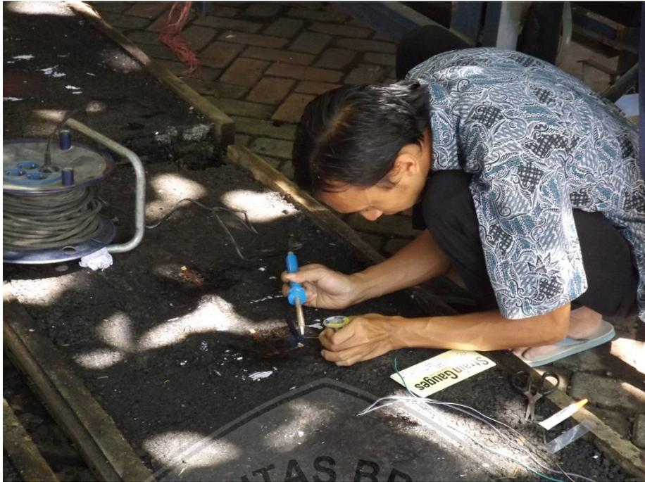
Gambar 4. 20 Pemasangan Strain Gauge
