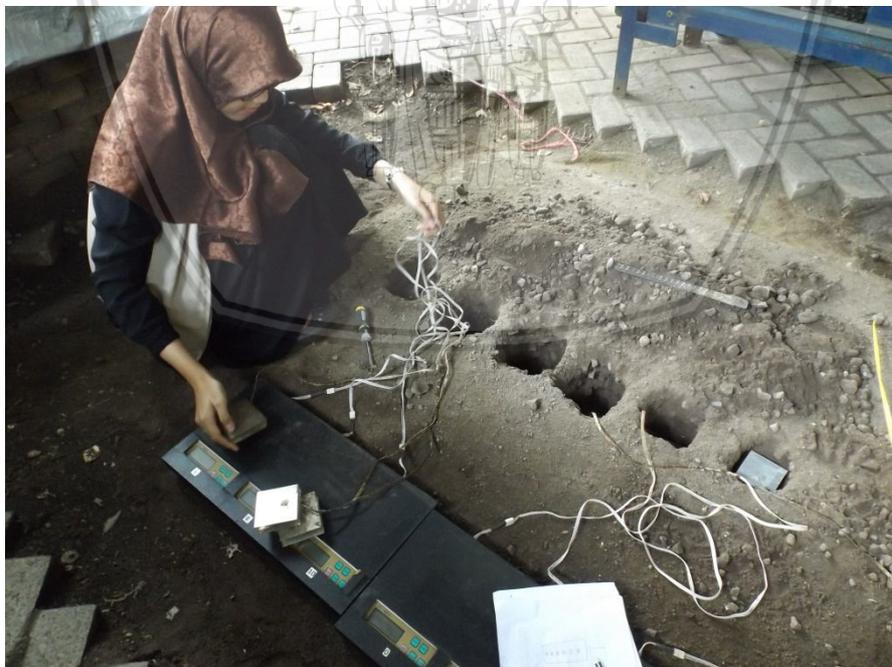
Gambar 4. 21 Pemasangan Sensor Pengukur Tegangan
