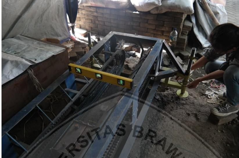
Gambar 4. 24 Pengaturan kedataran alat loading test
