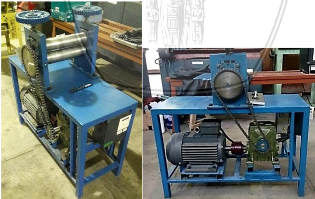
Gambar 3.1 Mesin *roll bonding*
