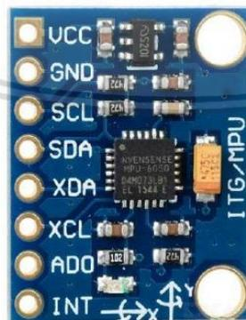
Gambar 2.16 Bentuk fisik Sensor IMU MPU6050
