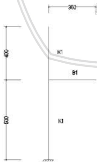
Gambar 4.30 Struktur portal yang ditinjau
