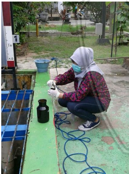
Gambar 4.22. Pengambilan sampel pada titik inlet
