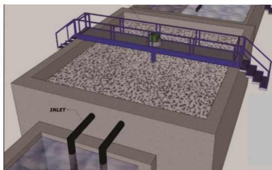
Gambar 4.13. Skema proses pengolahan air limbah pada Bak Equalisasi Sumber : Rizki Design IPAL Margasari, 2017
