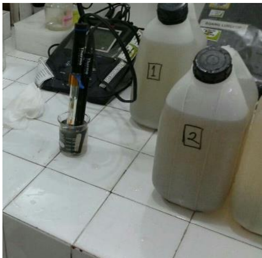
Gambar 4.27. Pengujian sampel untuk parameter pH Sumber : Dokumentasi lapangan, 2017
