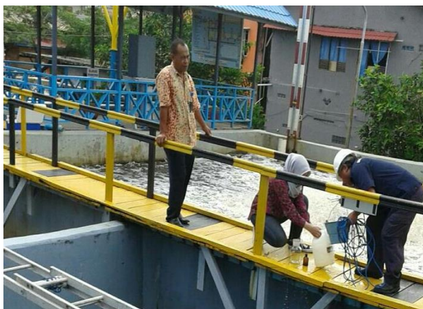
Gambar 4.23. Pengambilan sampel pada titik bak equalisasi Sumber : Dokumentasi lapangan, 2017
