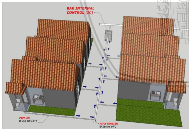
Gambar 4.5. Skema proses air limbah pada tiap rumah Sumber : rizki design
