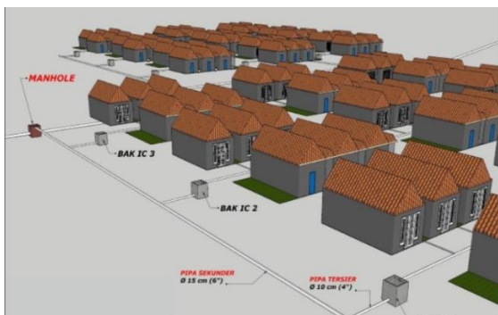
Gambar 4.6. Skema proses air limbah menuju manhole Sumber : rizki design
