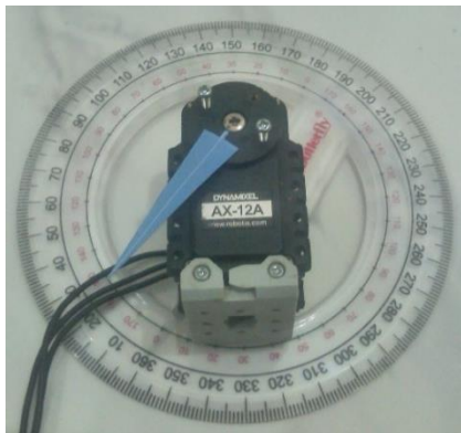
Gambar 4.6 Servo serial dynamixel yang digabungkan dengan busur 360° Sumber: Dokumentasi penulis
