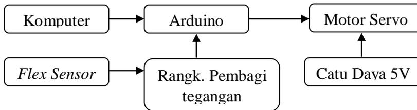
**Gambar 3.10** Diagram blok pengujian *flex sensor*
