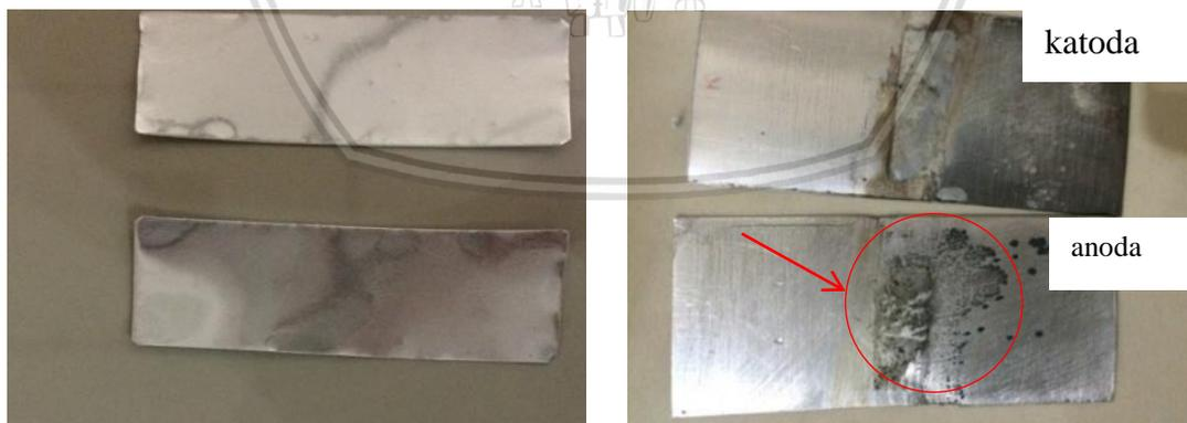
Gambar 4.5 Kondisi plat (a) sebelum proses dan (b) setelah proses elektrokoagulasi
