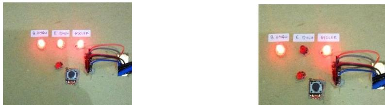
**Gambar 5.18 Hasil Output LED penyakit daun bawang Threshold  $\geq 90$**
