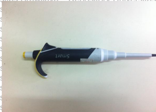
Gambar 4.8 Mikropipet yang digunakan dalam proses kalibrasi volume injeksi cairan sample
