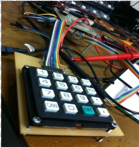
Gambar 4.3 Pengujian keypad dengan menggunakan multimeter
