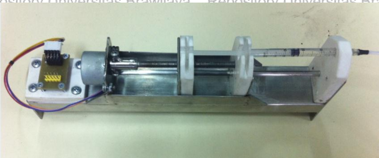
Gambar 4.5 Pengujian sistem penggerak motor stepper dan syringe pump
