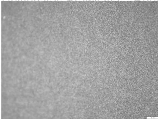
Gambar 4. 6 Morfologi Hasil *Etching* KOH Konsentrasi 35% Selama 1 Jam Menggunakan Mikroskop Optik Perbesaran 20x
