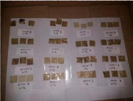
Gambar 4.5. Sampel hasil uji ketahanan lingkungan hingga hari ke-
