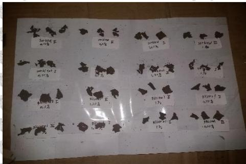
Gambar 4. 6. Sampel hasil uji biodegradabilitas
