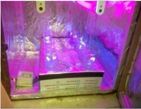
**Gambar C. 2** Fotoreaktor untuk degradasi senyawa metilen biru
