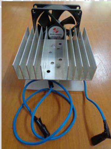
Gambar 4.2 *Solid State Relay* dengan *heatsink* dan kipas pendingin.
