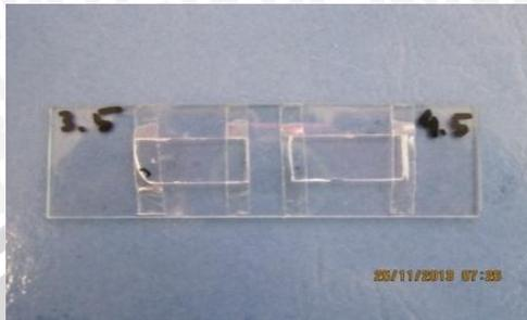
**Gambar 3.6** Posisi detektor CR-39 pada preparat
