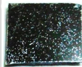
Gambar 4.9 Larutan PZT fase dry gel setelah dilapisi di atas substrat silikon dengan menggunakan spin coater
