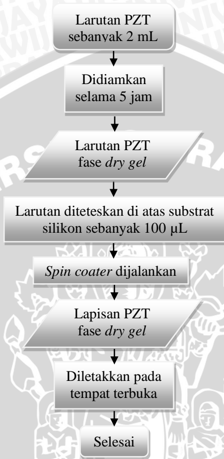
Gambar 3.11 Pembuatan lapisan tipis PZT dengan metode spin coating
