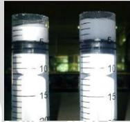
Gambar 4.8 Foto endapan silika, (kiri) pada  $T = 50\text{ }^{\circ}\text{C}$ , (kanan) temperatur ruang.
