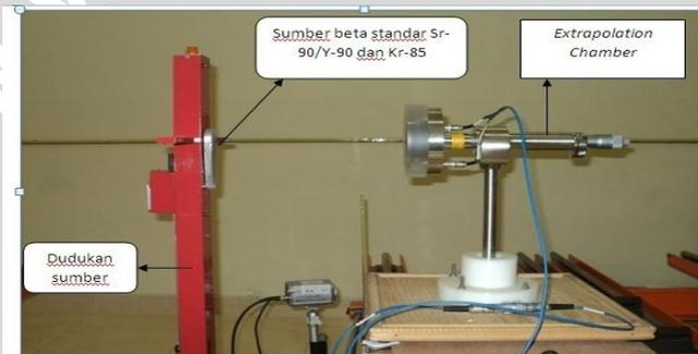
**Gambar 3.1** Laju Paparan Beta dengan *Bohm Extrapolation Chamber*
