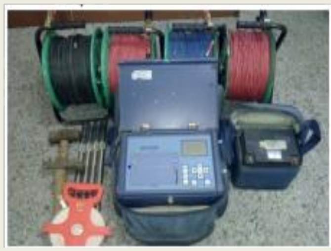
Gambar 3.2 Peralatan survei geolistrik.
