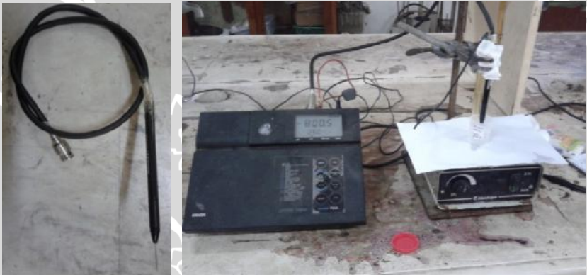
(a) (b) Gambar 4.1. Rangkaian pengukuran (a) dan kontruksi ESI bermembran D2EHPA (b)
