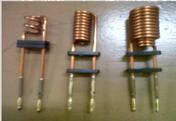
Gambar L. 11.4 tiga macam kumparan yang digunakan untuk mendeteksi radikal bebas
