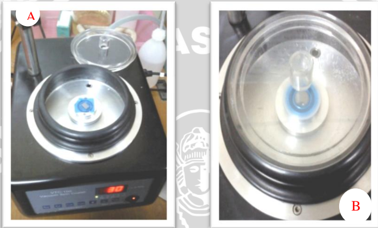
Gambar 4.7 Proses spin coating penelitian. A. Sampel diletakkan di atas holder spin coater . B. Proses pelapisan.
