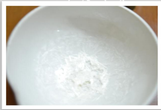
Gambar 4.4 Larutan prekursor PZT yang sudah dikeringkan (serbuk) dalam furnace pada temperatur 600 °C selama dua jam.
